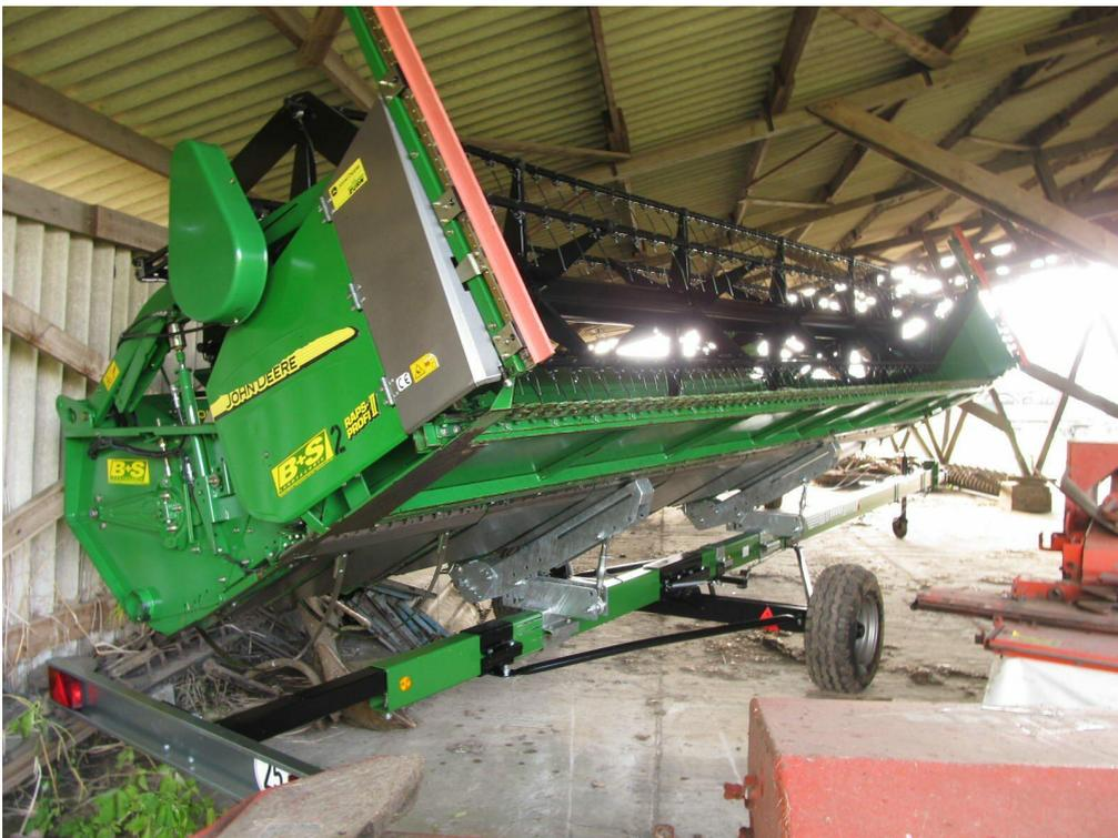
Bild 8: Schneidwerk
